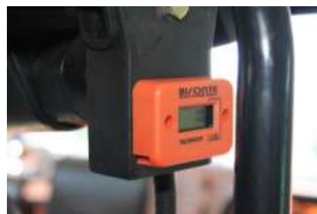
Dotare standard Contor ce afiseaza durata de utilizare si turatia motorului
