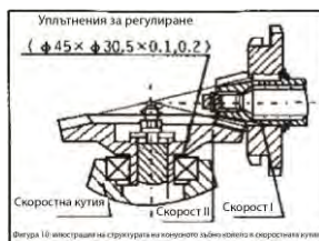
Фигура 10: илюстрация на структурата на коничното зъбно колело в скоростната кутия
